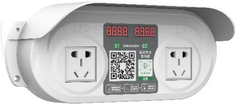
电动自行车智能充电桩NP-C02系列，由一台2路主控制器外加多套2路分控制器，每路控制器有2个供电端口，每路通道都有其独立的显示窗口与控制按键，用户在扫码后，控制器就会给对应通道的插座供电，并对电池进行检测，充满后会自动断电，并通过手机端告知用户充电完成和充电费用。考虑为适应不同型号的电动车，控制器输出的是220V电源，给电动车充电时还是需要插接上电动车自带的充电器。
